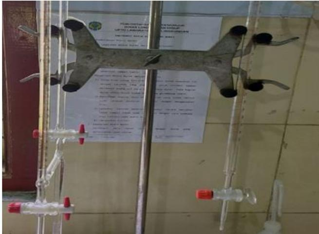
Figure 2 Mikroburet untuk Pengukuran BOD
