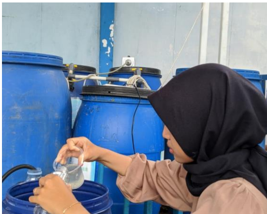
Gambar 7. Mengambil sampel air limbah yang akan diperiksa kadar amonia.
