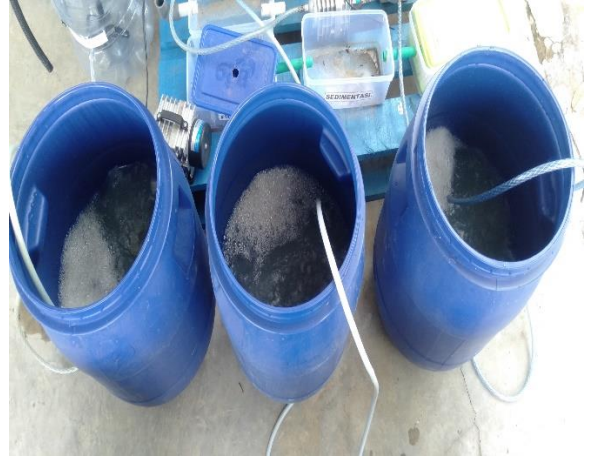
Gambar 6. Perlakuan aerasi selama 2jam, 4jam, dan 6jam.
