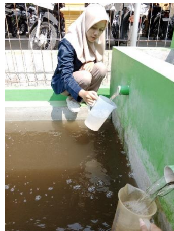
Pengukuran debit air limbah
