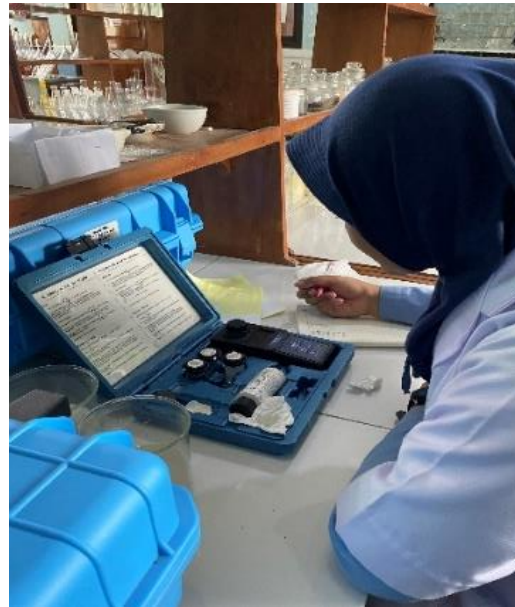
Gambar 12 Pemeriksaan Kekeruhan menggunakan turbidimeter
