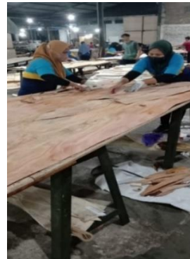
Bagian Repairing (Perbaikan lembaran triplek yang lubang atau rusak)
