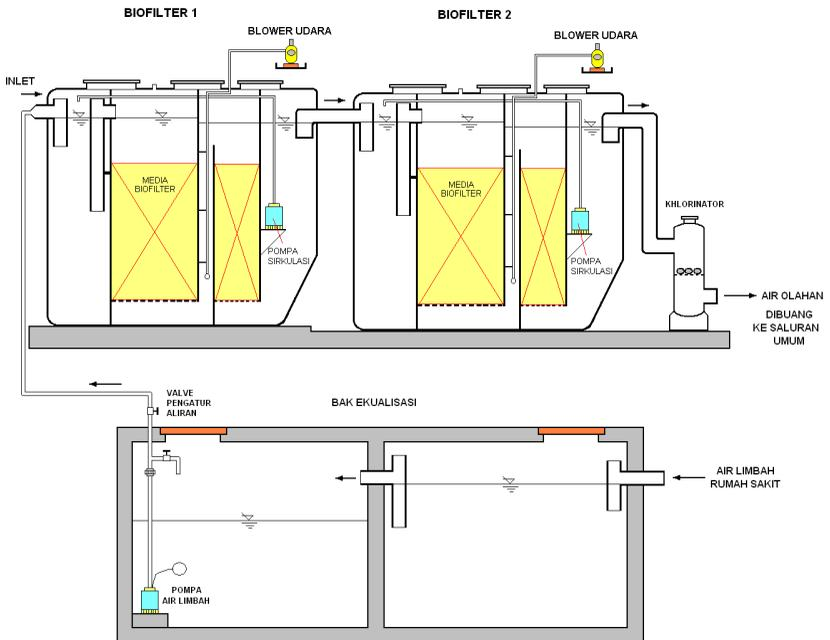
Gambar 2 : Diagram Proses Pengolahan Air Limbah Layanan Kesehatan Skala Kecil ( Kapasitas 5 m<sup>3</sup> per Hari)
