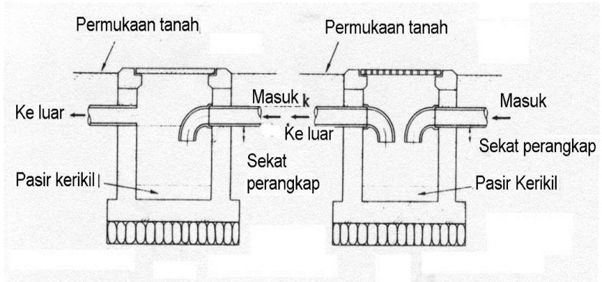
Gambar 3.2 : Contoh Konstruksi Bak Kontrol.
