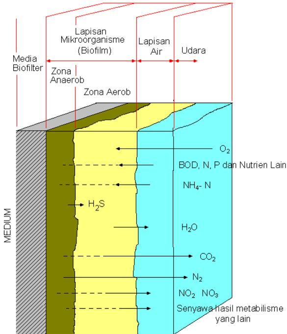
Gambar 2.2 : Mekanisme Proses Metabolisme Di Dalam Sistem Biofilm.
