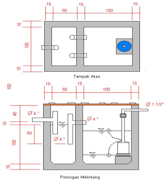
Gambar 3.3 : Salah Satu Contoh Tipikal Konstruksi Bak Pengumpul.
