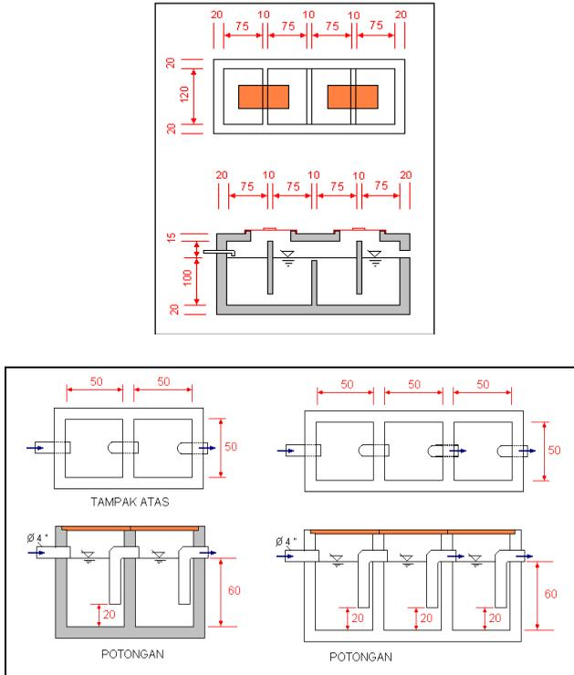
Gambar 3.6 : Contoh Konstruksi Bak Pemisah Lemak Sederhana.
