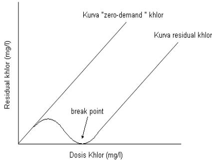
Gambar 3.34 : Kurva Kebutuhan Dosis Untuk Reaksi Khlorin Dengan Amonia.
