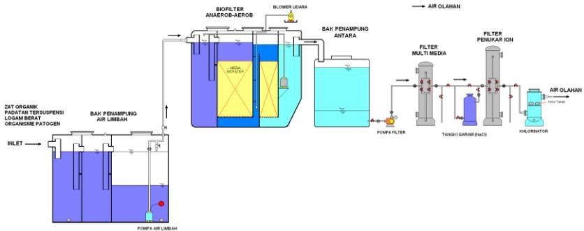
Gambar 5 : Pengolahan Air Limbah Layanan Kesehatan Skala Kecil Dengan Proses Biofilter Anaerob-Aerob, Penyaringan Dengan Filter Multi Media Dan Penyaringan Dengan Filter Penukar Ion.
