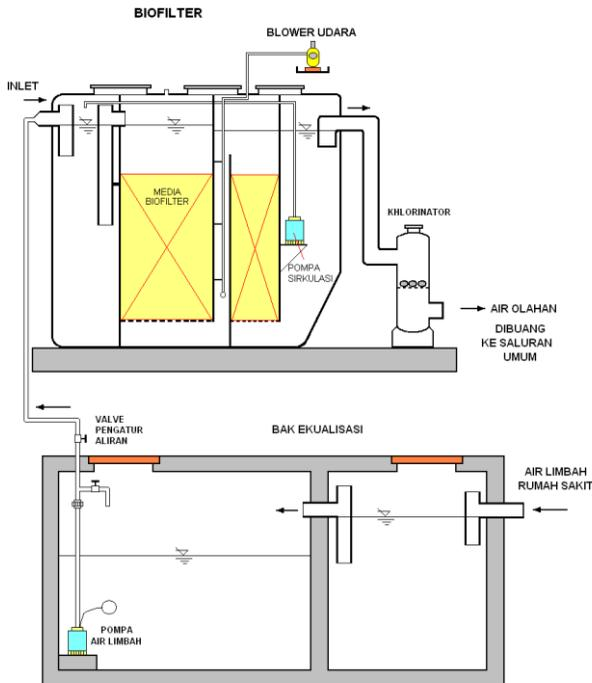
Gambar 1 : Diagram Proses Pengolahan Air Limbah Layanan Kesehatan Skala Kecil Menggunakan satu unit Reaktor Biofilter. Kapasitas  $2,5 \text{ m}^3$  per Hari.
