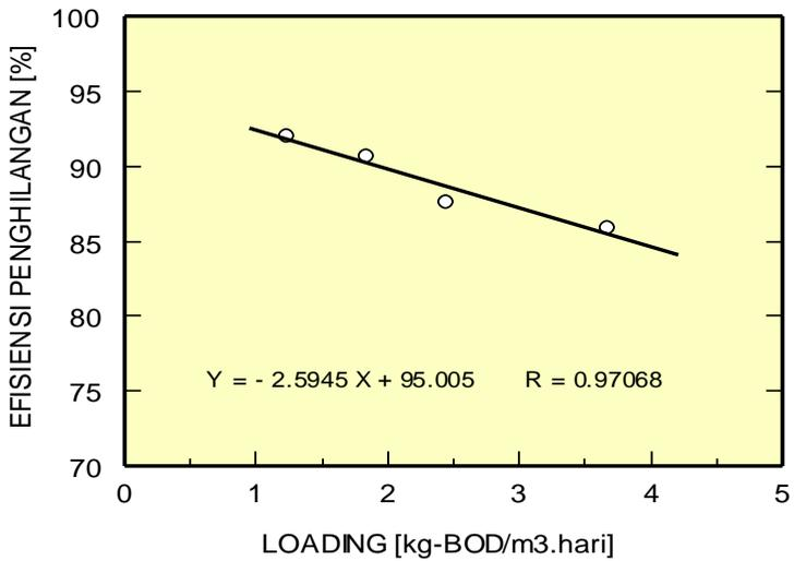
**Gambar 2.15 : Grafik Hubungan Antara Beban BOD (BOD Loading) Dengan Efisiensi Penghilangan Di Dalam Reaktor Biofilter Anaerob-Aerob.**
