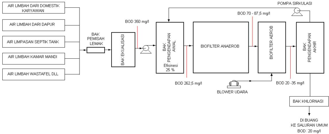
Diagram Proses Pengolahan Air Limbah Rumah Sakit Dengan Proses Biofilter Anaerob- Aerob.
