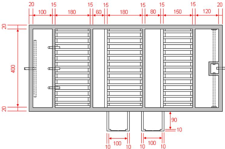
Konstruksi Reaktor dan Penyangga Media Biofilter.
