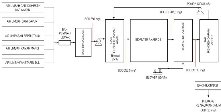
Gambar 1 : Diagram Proses Pengolahan Air Limbah Rumah Sakit Dengan Proses Biofilter Anaerob- Aerob.
