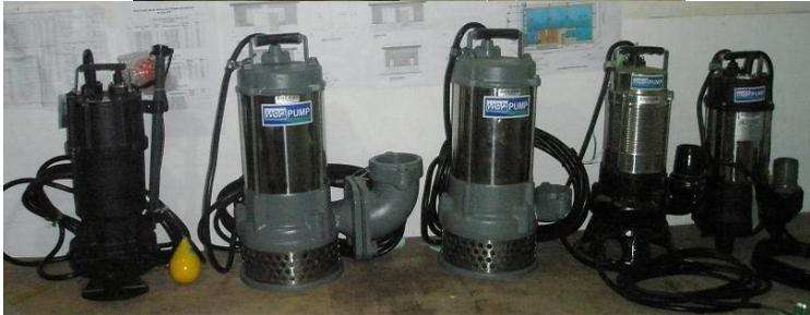
Gambar 3.16 : Jenis Pompa Celup Yang Sering Digunakan Untuk Pengolahan Air Limbah.
