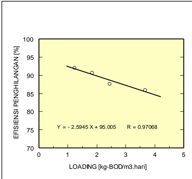
Gambar 2 : Grafik Hubungan Antara Beban BOD (*BOD Loading*) Dengan Efisiensi Penghilangan Di Dalam Reaktor Biofilter Anaerob-Aerob.
