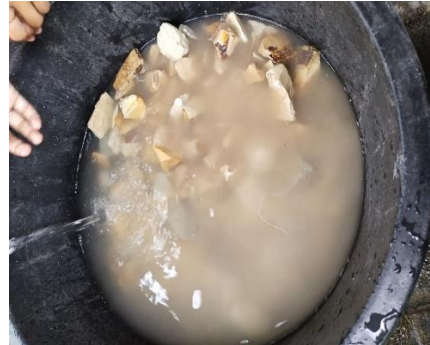
Pencucian Batu Zeolit sebelum digunakan
