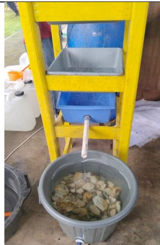
Perlakuan Tray Aerator dan adsorbsi batu zeolit
