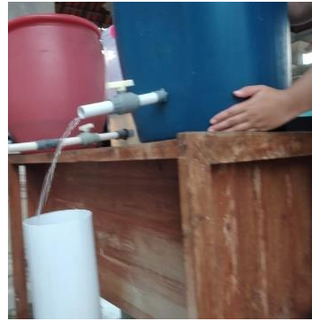
Gambar 22. Stop kran pada bak aerasi dibuka dan dialirkan ke bak filtrasi
