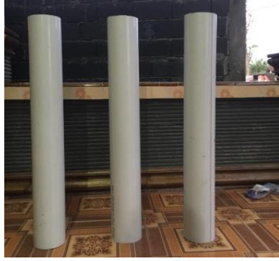
Gambar 13. Pembuatan bak filtrasi dari potongan pipa PVC 4 dim dengan panjang 70 cm
