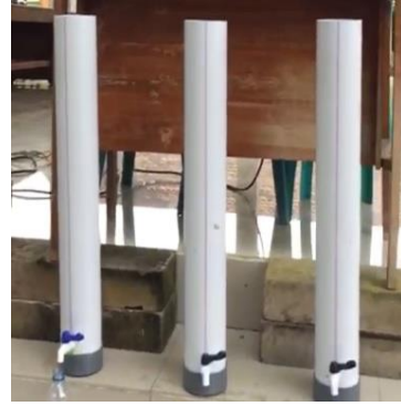
Gambar 14. Potongan pipa PVC 4 dim di pasangkan tutup pipa dan stop kran 1/2 dim
