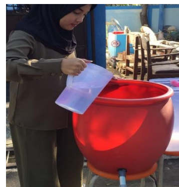
Gambar 18. Air Fe dituangkan ke bak aerasi
