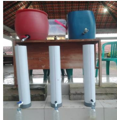
Gambar 16. Penataan bak aerasi dan bak filtrasi
