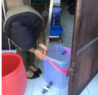
Gambar 8. Pengukuran volume bak aerasi
