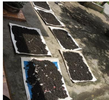
Gambar 10. Pengeringan pasir (media filtrasi) yang telah dicuci
