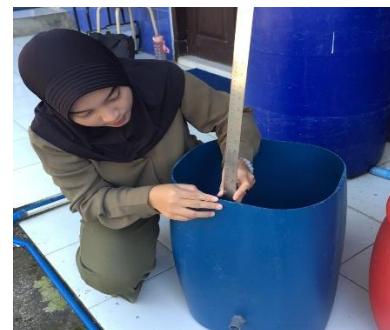
Gambar 6. Pengukuran volume bak aerasi
