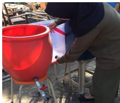
Gambar 5. Pemasangan kran pada bak aerasi
