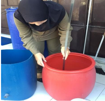
Gambar 7. Pengukuran volume bak aerasi
