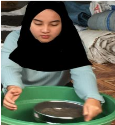
Gambar 11. Penyaringan pasir dengan ayakan berukuran 10 mesh
