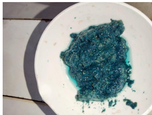
Gambar 10 Endapan yang terbentuk pada variasi dosis 2 gram
