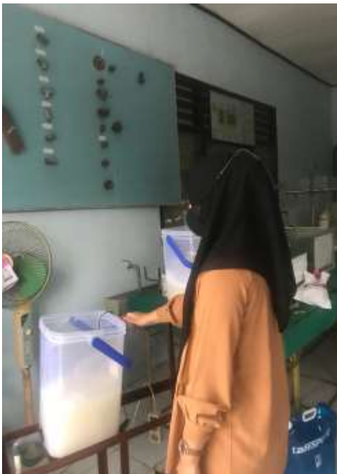
Mengalirkan limbah cair tahu ke bak aerasi
