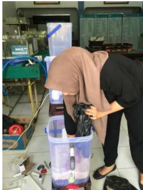
Penyusunan media Filtrasi
