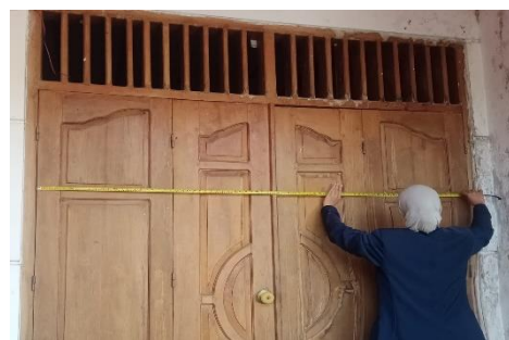
Pengukuran luas ventilasi rumah
