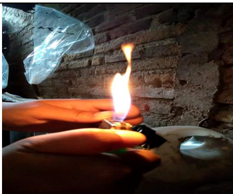
Pengujian Mulai Munculnya Gas Metan
