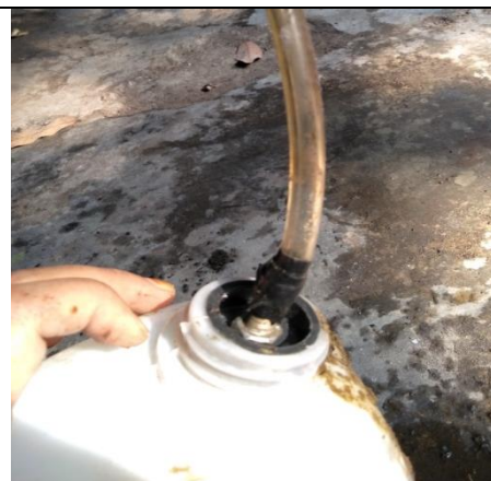
Pemasangan Selang Pada Ujung Pentil
