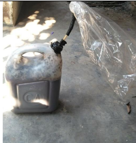
Digester Biogas Yang Sudah Terpasang Plastik Penampung Gas
