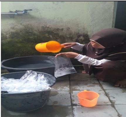
Plastik Bekas Penampung Gas Diisi Air Sesuai Ukuran Gas Yang Tertampung
