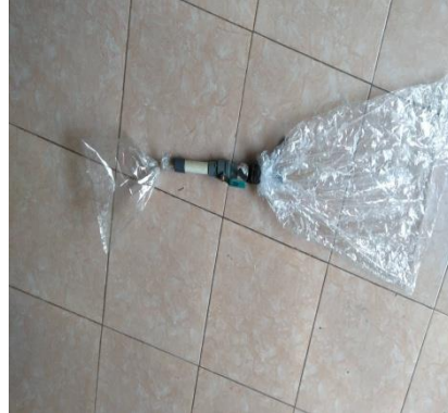
Pemindah Gas Dari Plastik Penampung Gas Digester Ke Plastik Penampung Seluruh Gas
