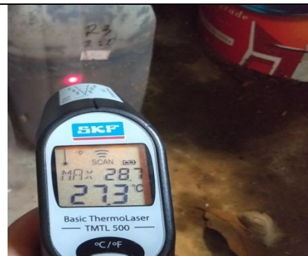
Pengukuran Suhu Pada Digester
