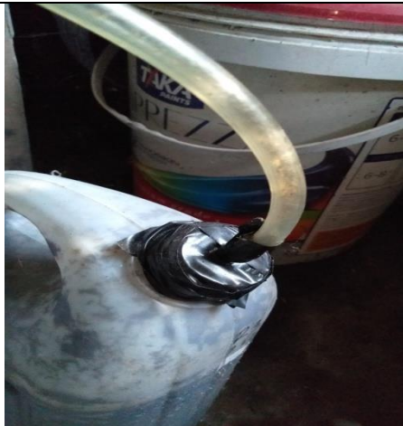
Tutup Derigen Dilapisi Isolatif dan Lem Agar Tertutup Rapat
