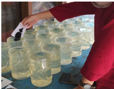
Gambar 3. Memasukkan karbon aktif kulit pisang kepok ( Musa acuminata ) ke dalam toples yang berisi air
