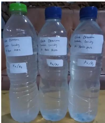
Gambar 11 Perubahan Fisik pada Limbah Laundry setelah Perlakuan Aerasi-Filtrasi pada Ketebalan Media Filtrasi 2
