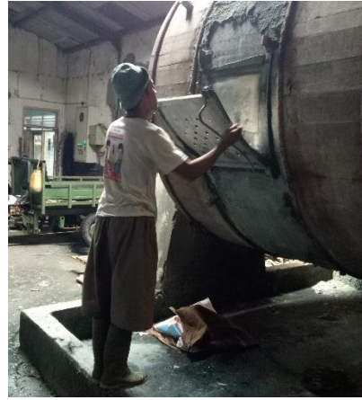
Pekerja yang menggunakan APD tidak secara lengkap
