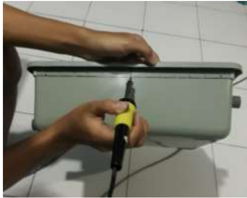
Pembuatan Lubang Untuk Tempat Kawat Tembaga
