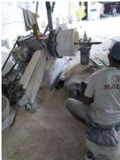
Gambar : Proses Pembubutan Marmer
