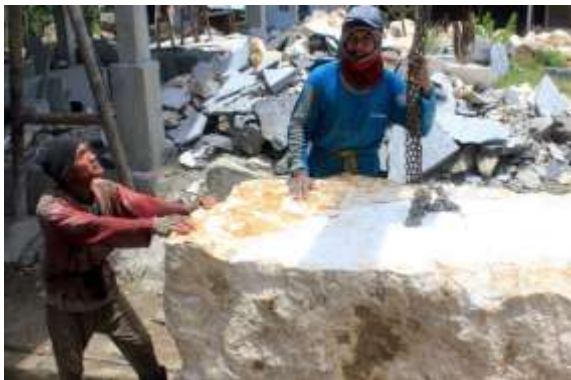
Gambar 3 : Pemandahan balok marmer Menggunakan katrol
