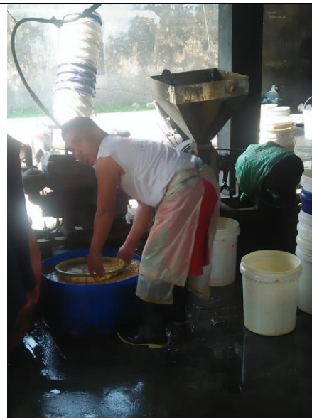
Proses penggilingan kedelai
