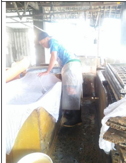
Proses penyaringan sari kedelai
