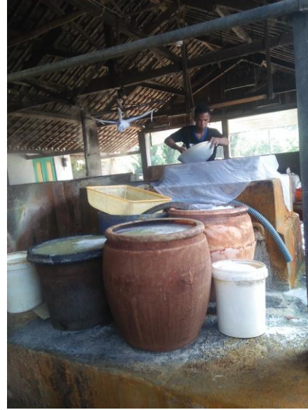
Proses penyaringan sari kedelai
