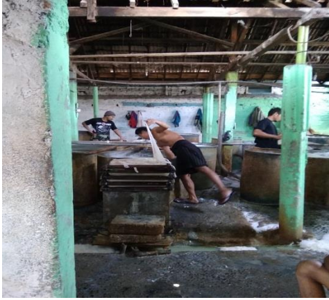
Unit Pencetakan atau pengepressan Pekerja tidak memakai APD sepatu boots
