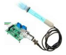
Fig. 2. pH Meter Module Sensor SKU-016
