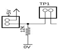
Fig. 4. Voltage divider
