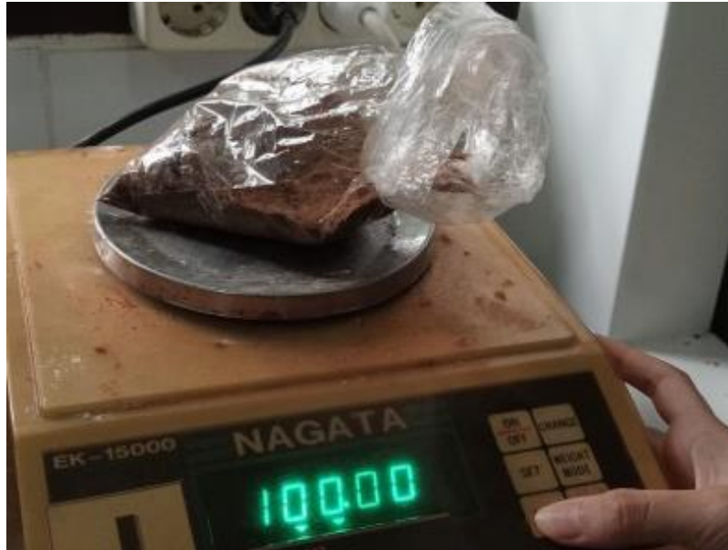
Gambar 3. Menimbang serbuk ekstrak kulit buah nanas ( Ananas Comosus L. Merr ) sebesar 100 gram
