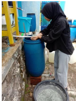
Gambar 9. Media adsorpsi dimasukkan dalam bak adsorpsi dengan ketinggian 25cm
