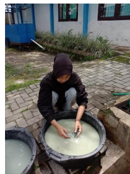
Gambar 6. Pencucian batu zeolit sebagai media adsorpsi
