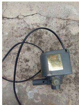
Gambar 3. Alat aerasi berupa aerator
