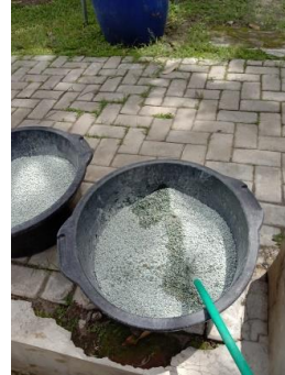
Gambar 8. Batu zeolit berukuran 0,5 cm
