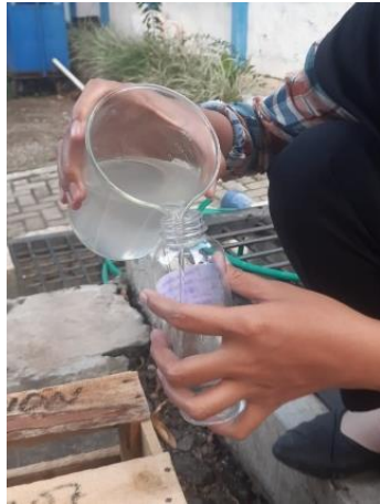
Gambar 13. Setelah dilakukan pengendapan 60, meny lalu dituangkan ke dalam botol sampel sesuai replikasi
