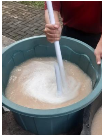
Gambar 11. Proses pengadukan cepat selama 5 menit dan dilanjutkan dengan pengadukan clambat 20 menit
