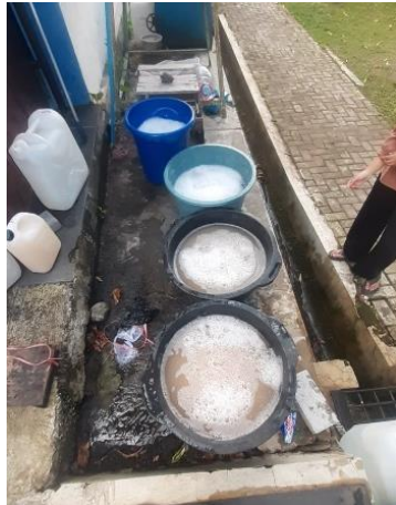
Gambar 9. Tuangkan sampel kedalam 4 bak berukuran 20 liter untuk dilakukan proses Yartest
