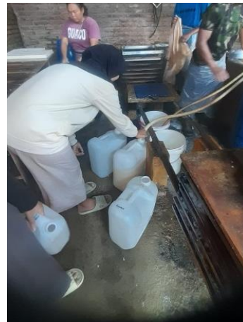
Gambar 8. Proses pengambilan sampel limbah cair tahu
