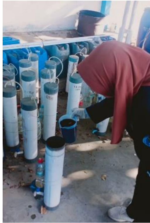
Memasukkan urine sapi ke alat fermentor
