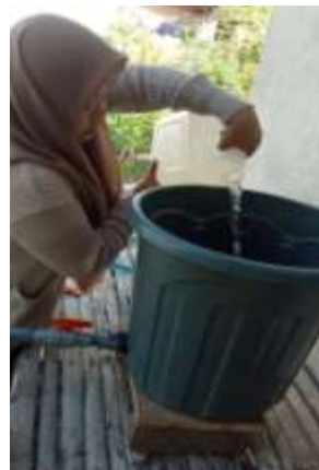
Pengambilan air Mn sebanyak 10 liter lalu dituangkan ke bak aerasi
