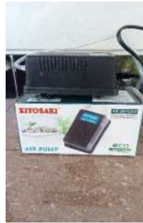
Alat aerasi berupa bubble aerator (AR-AP-Q3A)
