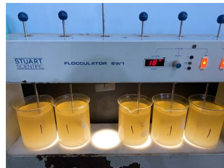
Gambar 10 Proses pengadukan cepat selama 15 menit dengan kecepatan 180 rpm dan di lanjut pengadukan lambat 5 menit dengan kecepatan 80 rpm
