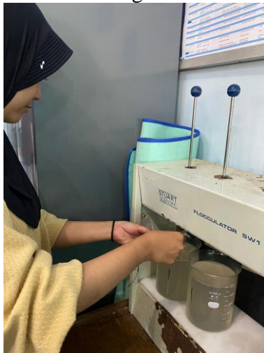
Gambar 9 Penuangan bubuk trembesi ke dalam limbah laundry yang sudah berada di flokulator
